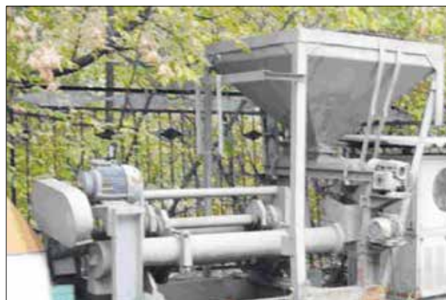
Рис. 2. Капсулятор-смеситель с рабочими камерами ГРК производительностью 5 м 3 /ч для капсуляции крупных заполнителей
