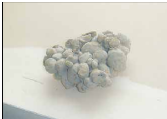
Рис. 7. Образец крупнопористого конструктивно-теплоизоляционного керамзитобетона (плотность 420–450 кг/м 3 ), взятый из мансардных наружных стен Fig. 7. A sample of large-pore structural and heat-insulating expanded clay concrete (density 420–450 kg/m 3 ) taken from mansard outer walls
