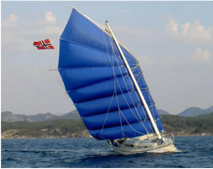
Рис. 4. Яхта с безтакелажной конической мачтой и конические элементы.
