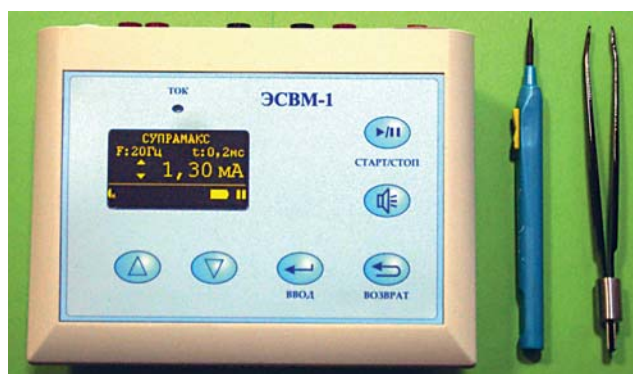
Рис. 1. Электростимулятор ЭСВМ-1 для интраоперационного визуального нейромониторинга
