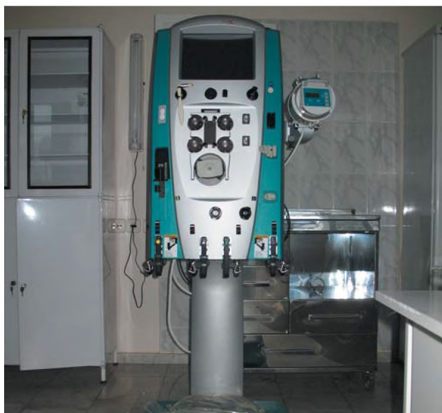
Рис. 1. Общий вид аппарата "PrizmaFlex" для проведения низкопоточной гемофильтрации
