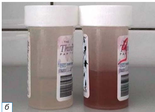
Рис. 2. Примеры шкалы визуальной оценки (а) и образцов (б): образец слева готов для приготовления стеклопрепарата, образец справа требует дополнительной обработки перед приготовлением стеклопрепарата.
