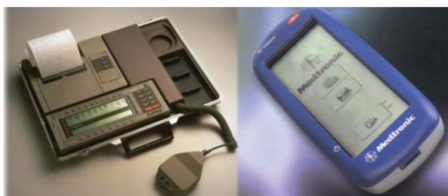
Рис. 7. Программатор врача для подбора программы стимуляции спинного мозга.
