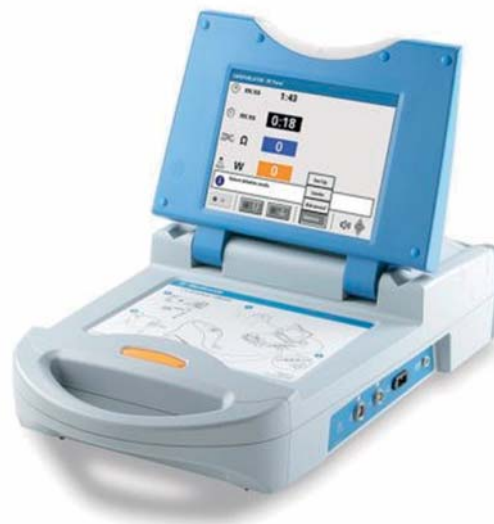
Рис. 1. Оборудование Medtronic: а — биполярный ирригационный зажим-электрод Medtronic Cardioblade Gemini-S; б — радиочастотный генератор Cardioblade Generator 68000.
